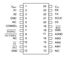
DS1616 24-Pin DIP (600 mil) DS1616S 24-Pin SOIC (300 mil)
