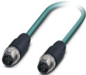
Konfektioniertes Ethernet-Kabel, CAT5e, geschirmt, 2-paarig, AWG 26 flexibel (7-drähtig), RAL 5021 (wasserblau), M12-Stecker auf M12 Stecker, Line, Länge 5 m
