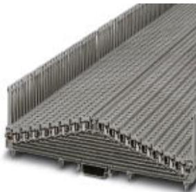
Potenzialverteiler, Nennspannung: 250 V, Nennstrom: 10 A, Querschnitt: 0,14 mm<sup>2</sup> - 1,5 mm<sup>2</sup>, AWG: 14 - 26, Anschlussart: Zugfederanschluss, Breite: 7,62 mm, Länge: 225 mm, Farbe: grau, Montage: NS 35/7,5, NS 35/15
