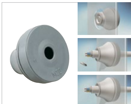
KABELDURCHFÜHRUNGSTÜLLEN (Für Materialstärken von 1-4 mm Dicke) Material: EPDM – Halogenfrei Schutzart: IP67 nach EN 60592 Temperaturbereich: -40°C bis + 110°C
