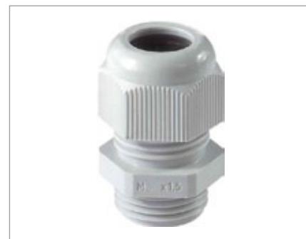
KABELVERSCHRAUBUNGEN (Für Materialstärken von 1-4 mm Dicke) Material: Polyamid Schutzart: IP68 nach EN 60592 Temperaturbereich: -20°C bis + 100°C
