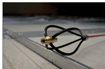
Le fouet permet de passer des obstacles.
