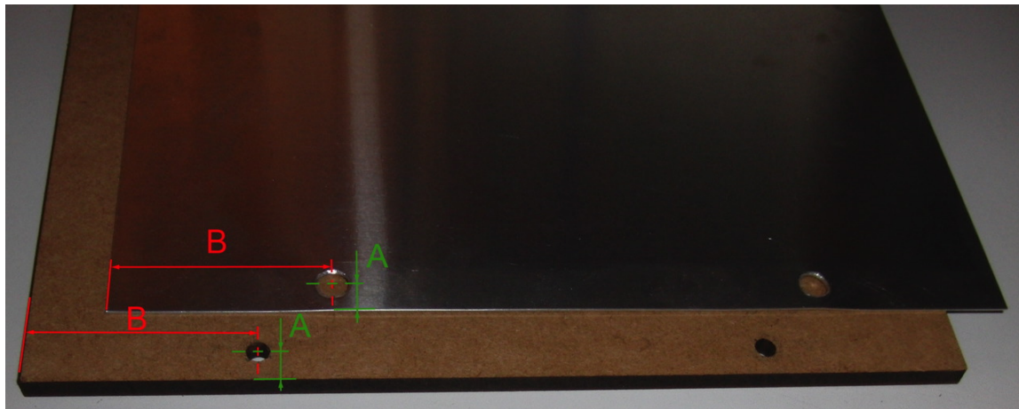
Abbildung 3.161. Bohrungslöcher Alu-Platte(nur wenn kein Heizbett verbaut wird)
