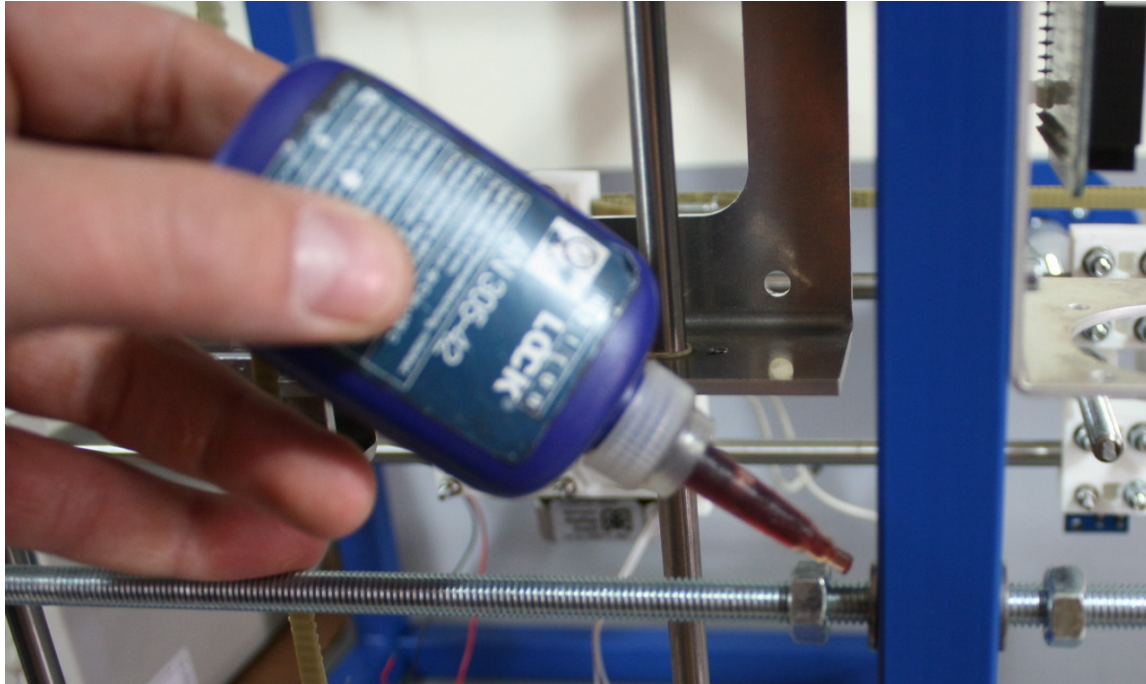
Abbildung 5.9. Montage der Muttern mit Schraubensicherung (empfohlen)
