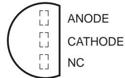
LM285-2.5, LM385-2.5, LM385B-2.5 . . . LP PACKAGE (TOP VIEW)
