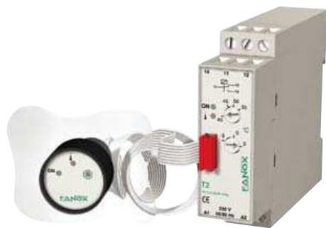
Thermostat zur Überwachung der Umgebungstemperatur, speziell von Elektromotoren von Aufzügen sowie Elektroniken von Steuereinheiten, interner oder externer NTC-Sensor frontseitig anschließbar. Kontakt 1 Wechsler.
