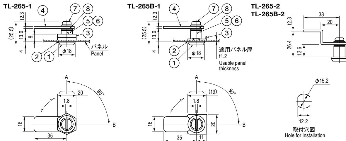
仕様 Specification TL-265 : ナット取付タイプ / TL-265B : リテナー取付タイプ TL-265 : Nut Type / TL-265B : Retainer Type
