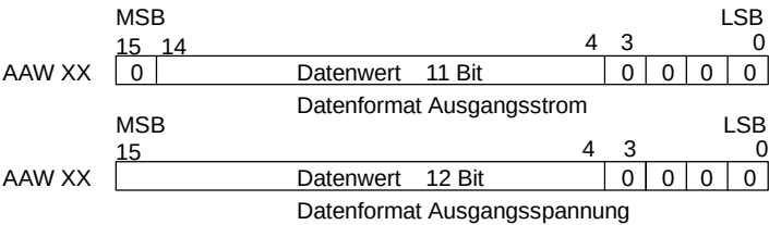
Bild A-17 Datenwortformat der Ausgänge beim EM 232 und EM 235
