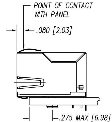
1. THE SUGGESTED PANEL OPENING IS INTENDED TO GIVE THE USER THE ABILITY TO HAVE REASONABLE JACK / PANEL CLEARANCES YET MAINTAIN RELIABLE GROUNDING CAPABILITY.
