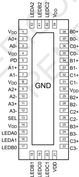
**Pin Configuration (42-TQFN ZL, Top-Side View)**
