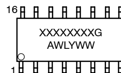
SOIC-16 D SUFFIX CASE 751B
