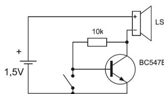
Ein Widerstand wird eingesetzt, um einen Strom zu verkleinern. In diesem Fall sorgt der Widerstand für einen Basisstrom von nur etwa  $0,1\text{ mA}$ . Der Transistor verstärkt diesen kleinen Strom 300-fach bis auf etwa  $30\text{ mA}$ . Zwischen Basis und Emitter des Transistors befindet sich ein Schalter. Wenn er geschlossen wird, leitet er den Basisstrom ab. Damit fließt auch kein Kollektorstrom mehr. Durch Öffnen und Schließen des Kontakts können Sie also ein Geräusch erzeugen.
