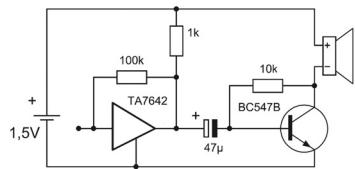
Berühren Sie den Eingang mit dem Finger. Wahrscheinlich hören Sie ein Brummen, Rauschen oder Prasseln. Eine Betätigung eines Lichtschalters im Raum sollte als Knacken hörbar werden. Die Schaltung ist damit bereits ein einfacher Hochfrequenzempfänger, der zumindest schon Funkstörungen aufnehmen kann.
