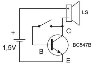
Bauen Sie einen Drahtschalter zwischen Basis und Kollektor. Bei geöffnetem Schalter fließt kein Strom durch den Transistor und den Lautsprecher. Wenn Sie die Batterie einsetzen, entsteht deshalb kein Geräusch. Erst wenn Sie mit dem Schalter einen Basisstrom einschalten, hören Sie ein Knacken. Achtung! Die Basis darf nur gegen den Kollektor kurzgeschlossen werden, aber auf keinen Fall gegen den Pluspol der Batterie.
