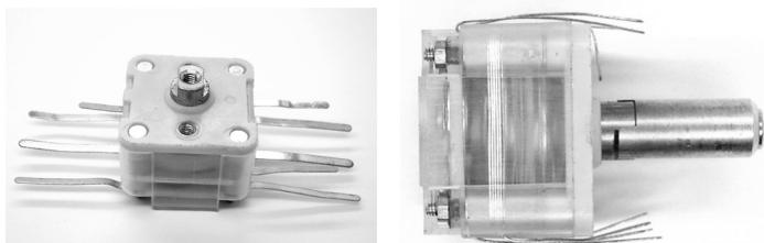
Der Drehko besitzt eine Mittellwellenseite mit zweimal 280 pF und eine UKW-Seite mit zweimal 20 pF. Zusätzlich gibt es für jedes Segment einen kleinen Trimmkondensator mit jeweils ca. 20 pF, der mit
