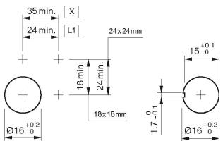
L1 = Löt-/Steckanschluss 2.8 x 0.5 mm
