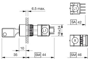
L1 = Löt-/Steckanschluss 2.8 x 0.5 mm
