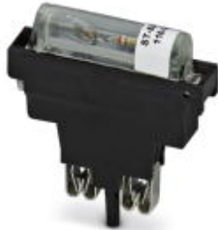
Sicherungsstecker, Nennstrom: 10 A, Länge: 45,4 mm, Breite: 9,9 mm, Farbe: schwarz
