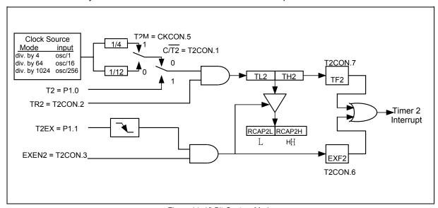
Figure 14. 16-Bit Capture Mode
