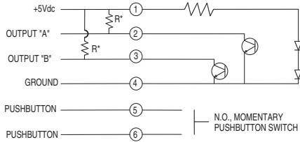
R\* - TWO 2.2KΩ RESISTORS REQUIRED FOR OPERATION.
