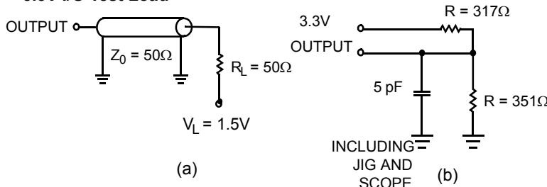
**2.5V I/O Test Load**
