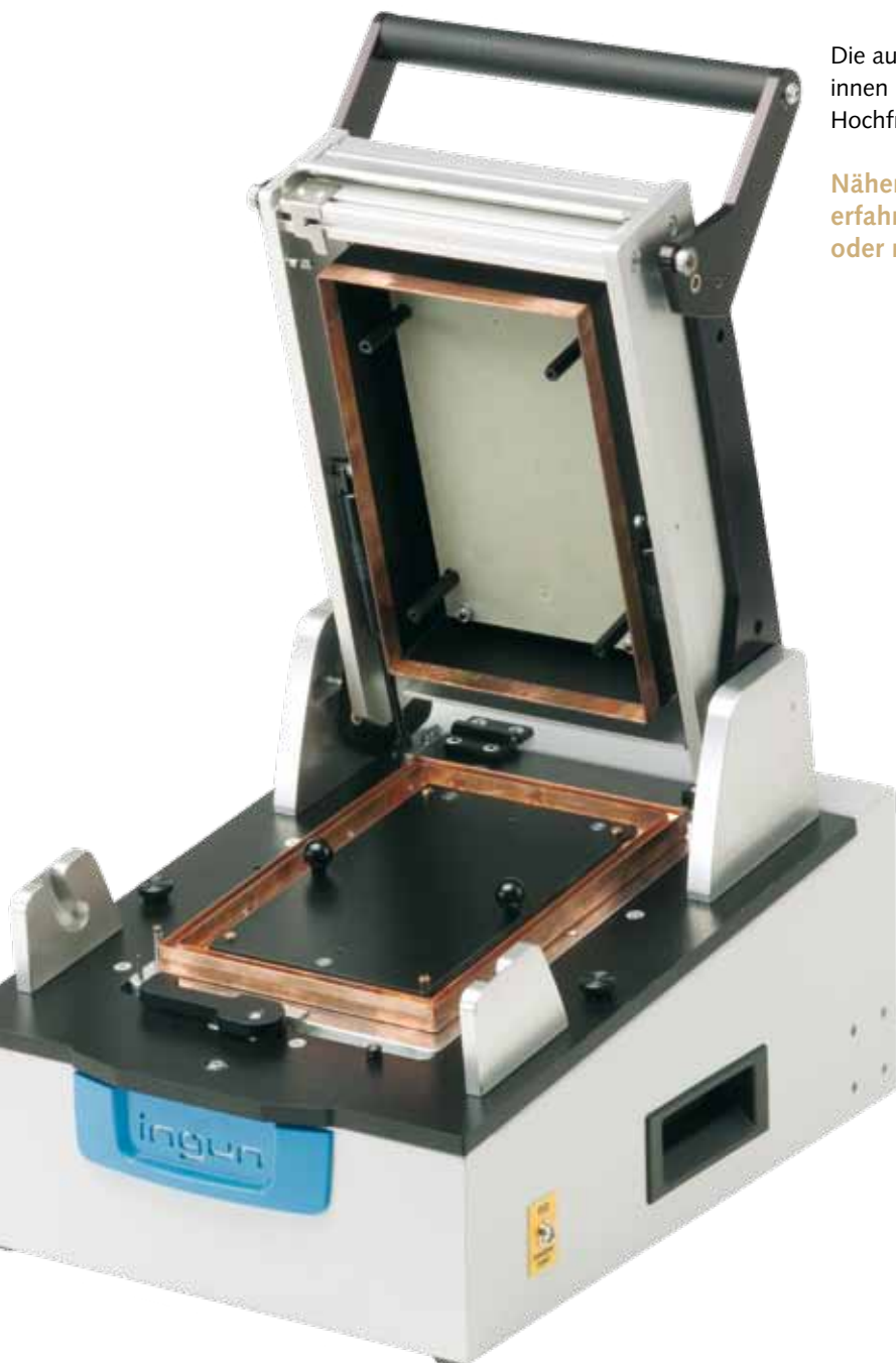
Hochfrequenz-Prüfadapter auf Basis MA 2111 mit ATS 2111/HF
