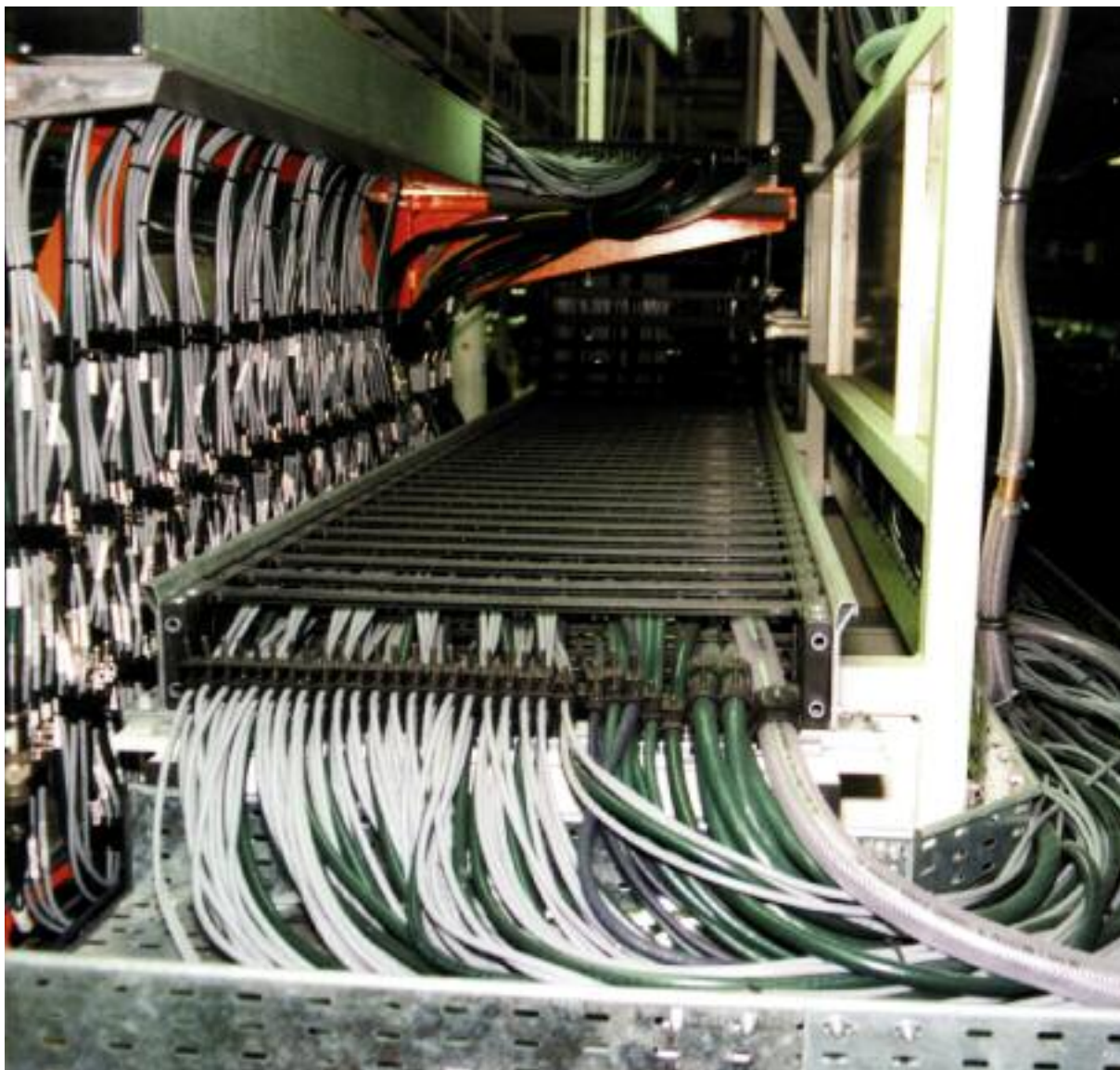
Chainflex® CF5 und CF6 Steuerleitungen (grün) sowie CF211 Messsystem-Leitungen (grau) in einer Schrauberstation im Automobilwerk. E-Kette®: System E4/100 mit Chainfix Clip Zugentlastung.
