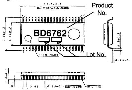
SSOP-B40 (Unit: mm)
