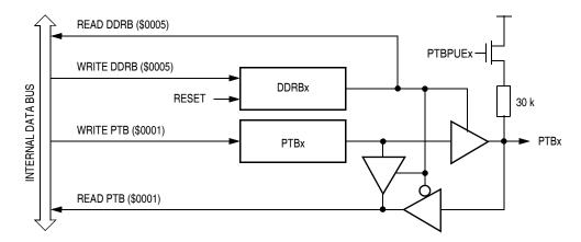
Figure 12-7. Port B I/O Circuit
