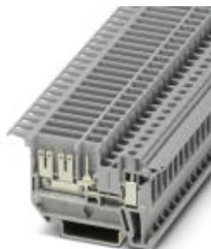
Durchgangsklemme, Anschlussart: Schraubanschluss, Flachsteckanschluss, Querschnitt: 0,2 mm<sup>2</sup> - 4 mm<sup>2</sup>, AWG :20- 14, Breite: 6,2 mm, Farbe: grau, Montage: NS 35/7,5, NS 35/15
