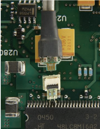
InfiniiMax ZIF tip soldered on board
